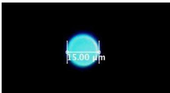
**Figura 39.** Perla fluorescente vista en un aumento de x40, el diámetro de la perla es de 15  $\mu\text{m}$ , la escala tomada como referencia para realizar las mediciones.
